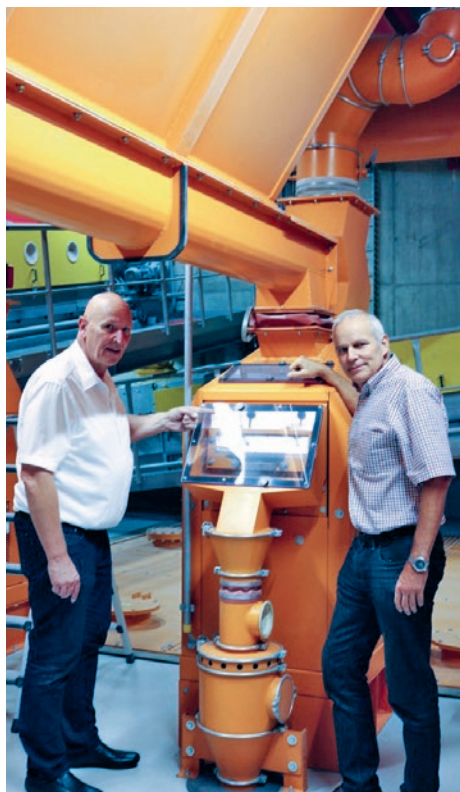
Urs Eberhard und Daniel Böni (rechts), an den Trenntischen, wo Aluminium von Kupfer und Edelmetallen getrennt wird.
